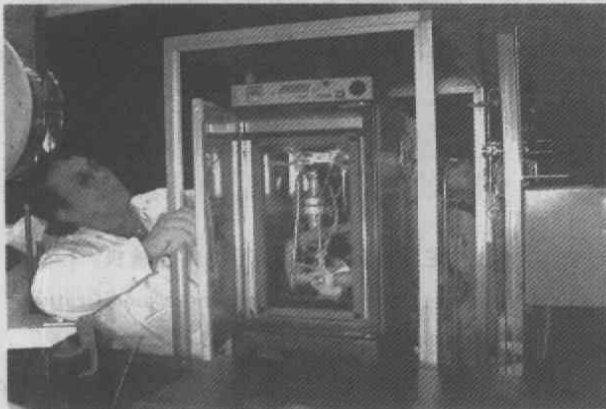
图 3 ABL 加热室(用于化学反应加热和汽化碘)
