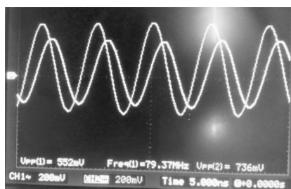
图3 改进外差干涉光路信号
