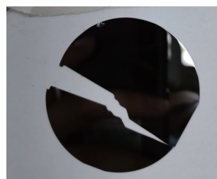
(a) 基底损伤实物图
