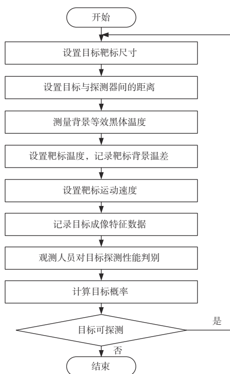
图3 动目标探测性能实验评估流程
