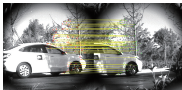
图 7 相邻 2 个子图像的特征点匹配 Fig. 7 Feature point matching of two adjacent sub-images
