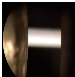
图 6 微腔表面显微镜照片 ( 200\times )
