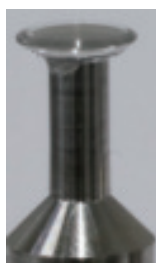
图 4 加工后的回音壁微腔
