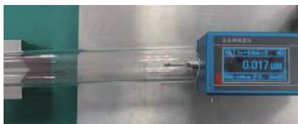
图 5 抛光后皮料管内表面粗糙度测试
