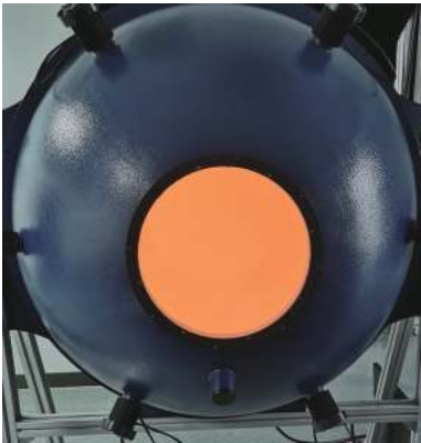
图 3 大口径积分球光源实物图(拍摄加灯照明情况下的实物照片)
