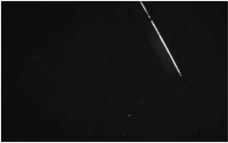
图 11 在位检测系统测得的某条划痕
