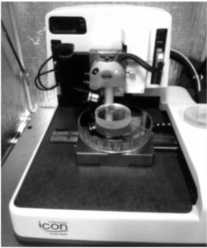
图 9 原子力显微镜检测表面疵病
