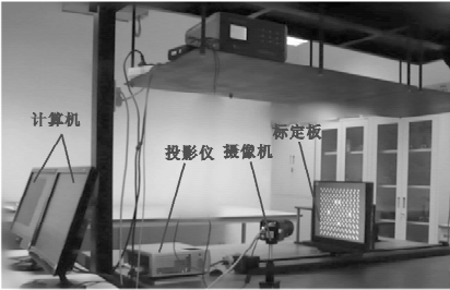
图 4 测量系统组成图
