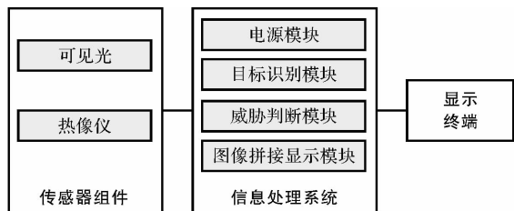
图 1 车载 360°态势感知系统组成图
